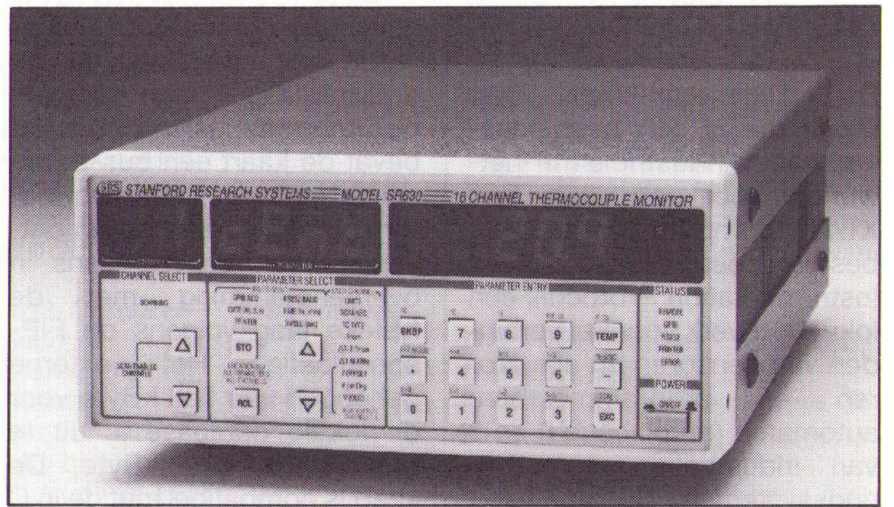
Temperaturen meten via thermokoppels over 16 ingangskanalen.
